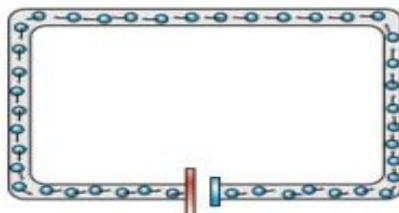
**Donc le passage du courant électrique dans les conducteurs électriques est dû au mouvement des électrons dans le sens contraire du courant électrique.**
