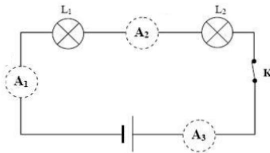
On constate que les ampèremètres A<sub>1</sub>, A<sub>2</sub> et A<sub>3</sub> indiquent la même intensité.
