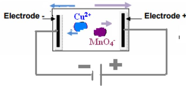
**Donc le passage du courant électrique dans les conducteurs électrolytiques est dû au mouvement des cations dans le même sens du courant et celui des anions dans le sens contraire du courant électrique.**
